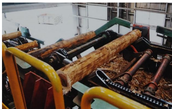
原木を切削機で桂剥きにして薄い単板にする（提供：日新）
