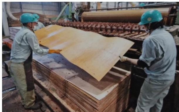
乾燥した単板を接着剤で貼りつける（提供：日新）
