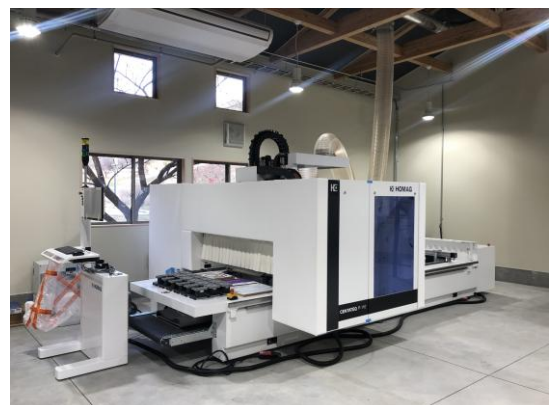
曲面加工も可能な5軸 CNC マシン（同社 HP より）
